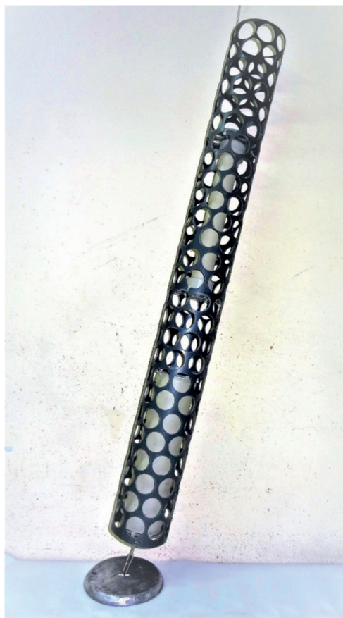
Рис. 1. Фотография измерителя скорости течения ТСМ. Его форма образована цилиндрической перфорированной пластиковой трубой. Перфорация препятствует развитию автоколебаний тела в набегающем потоке. Внутри находится прибор, осуществляющий измерение и регистрацию углов наклона, и модули плавучести. Весь плавучий пакет прикреплен к свинцовой пластине куском цепи [4]. Оригинальным здесь является конкретное техническое решение, а сама физическая идея измерять скорость набегающего потока по наклонению подвешенного тела с положительной плавучестью была ранее реализована Виталием Шереметом в Институте океанографии в Вудс Холе
