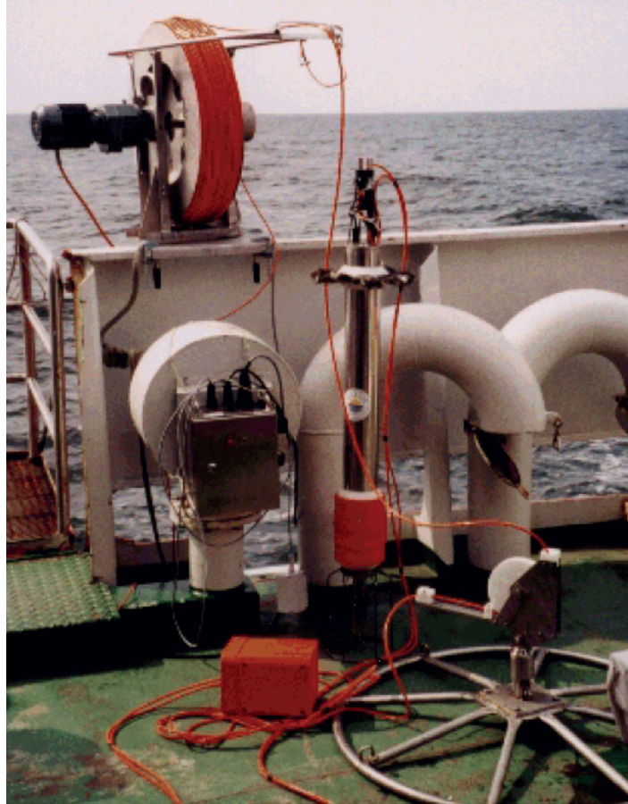
Рис. 3. Фотография микроструктурного зонда MSS profiler Хартмута Прандке [6]. Сравните с рис. 2 и найдите хотя бы одно существенное различие
