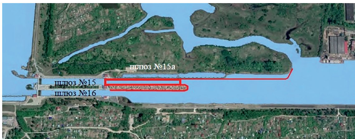
Рис. 4. Вариант строительства второй камеры шлюза № 15А
