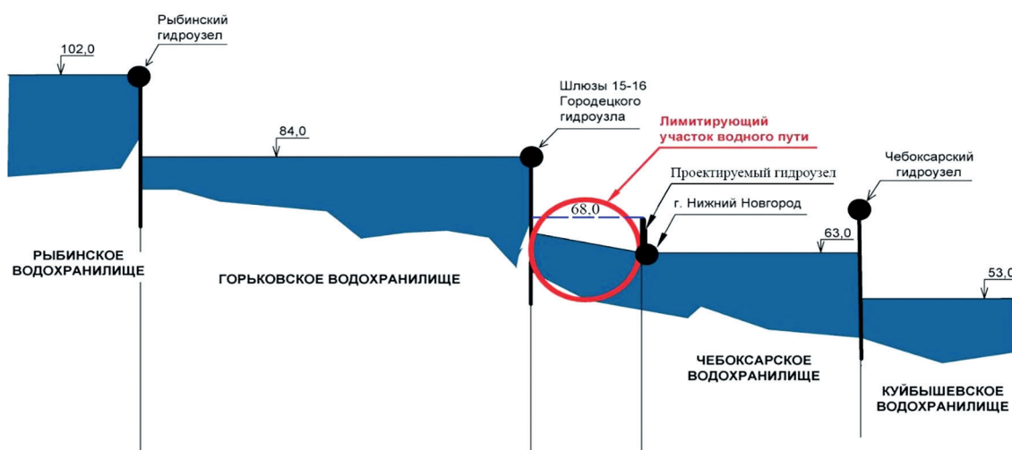
Рис. 1. Схема р. Волги от Рыбинского до Куйбышевского водохранилища. Цифрами обозначены нормальные подпорные уровни в метрах Балтийской системы
