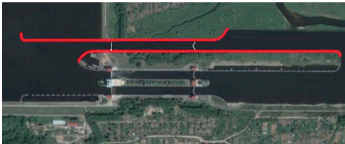
Рис. 3. Вариант строительства третьей нитки судоходного шлюза
