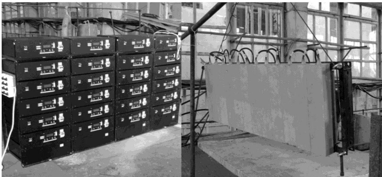
Рис. 7. Гидроакустическая параметрическая антенна для мониторинга океана на протяженных трассах. Слева — 24 канальный усилитель мощности антенны.
