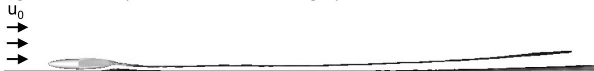
Рис. 4. Всплытие вихревого жгута за эллипсоидом вращения удлинением 6:1 при его движении в стратифицированной жидкости над пикноклином
