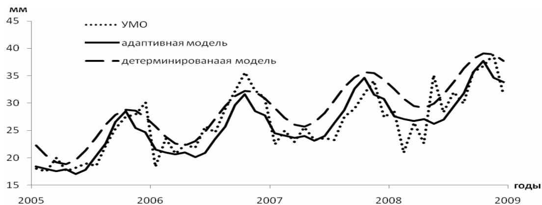
Рис. 3. Сопоставление фактических и предвычисленных по адаптивной и детерминированной моделям среднемесячных значений УМО по независимым данным за 2005-2008 гг.
