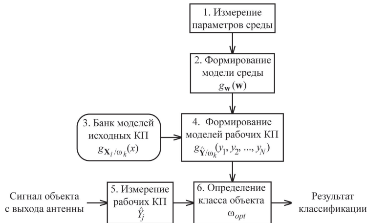
Рис. 4. Структура алгоритма классификации, согласованного со средой распространения сигнала.
