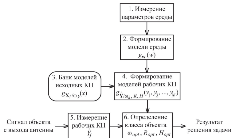
Рис. 5. Структура алгоритма совместного решения задач классификации и определения координат морских объектов, согласованного со средой распространения сигнала.
