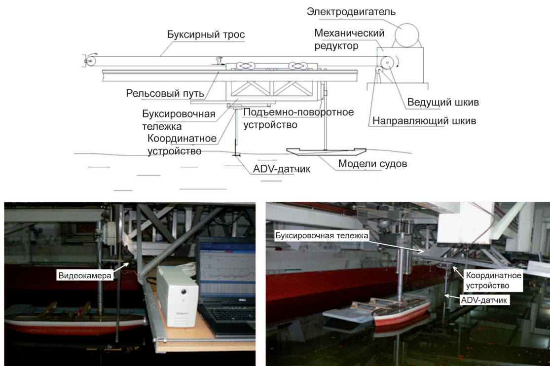
Рис. 2. Схема экспериментальной установки в опытном бассейне ВГУВТ.
