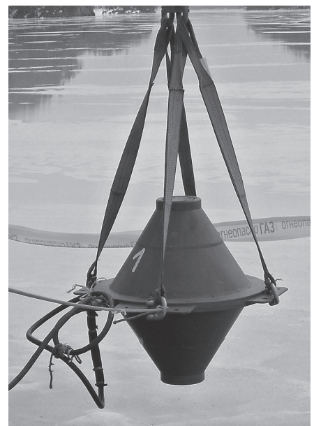
Рис. 1. Бикон TM — монополь встречно-поршневого типа с излучающим корпусом.
