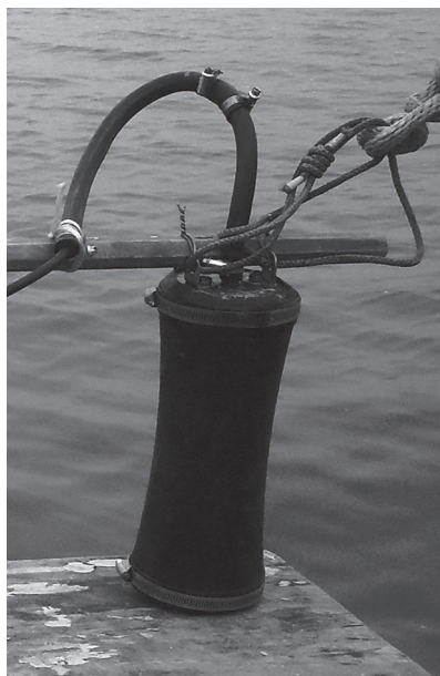
Рис. 2. Малогабаритный НЧИ продольно-изгибного типа.
