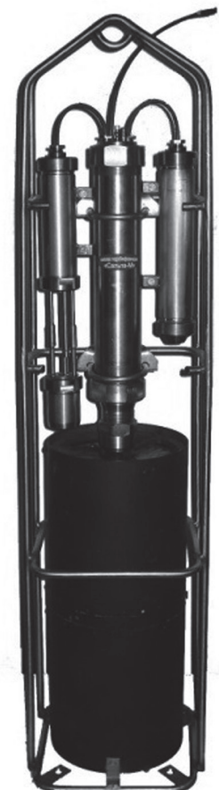
Рис. 5. Погружной модуль мультипараметрического гидробиофизического комплекса «Сальпа-М».
