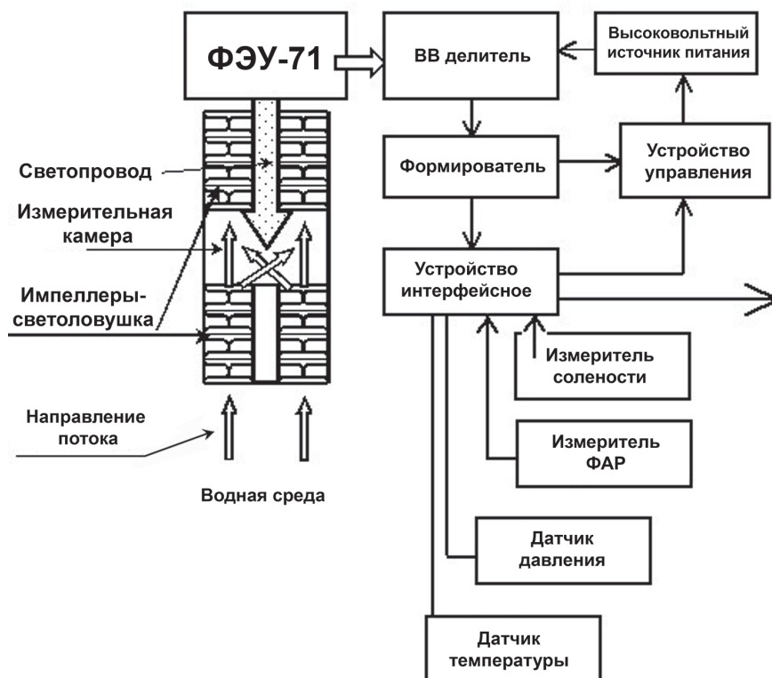
Рис. 6. Структурно-функциональная схема погружного модуля «Сальпа-М».
