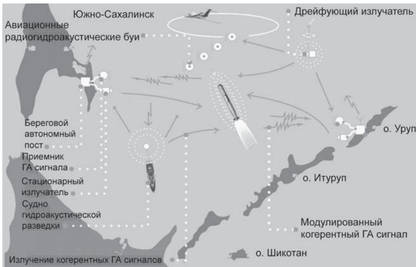
Рис. 5. Состав гидроакустической системы контроля подводной обстановки на основе выявления гидрофизических возмущений морской среды.
