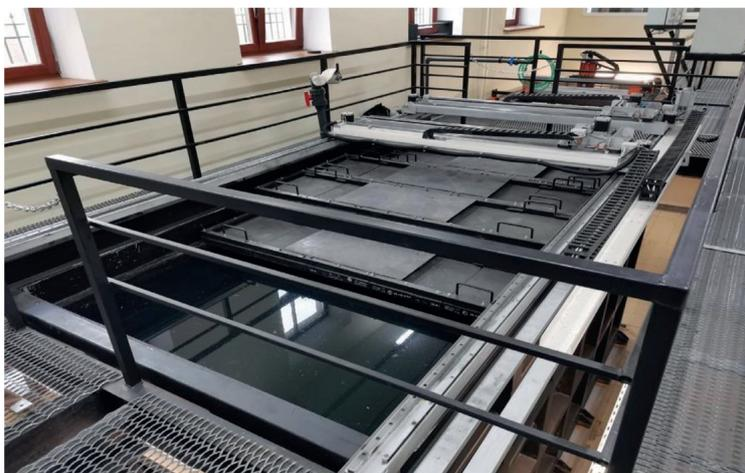
Рис. 1. Внешний вид гидроакустического бассейна
