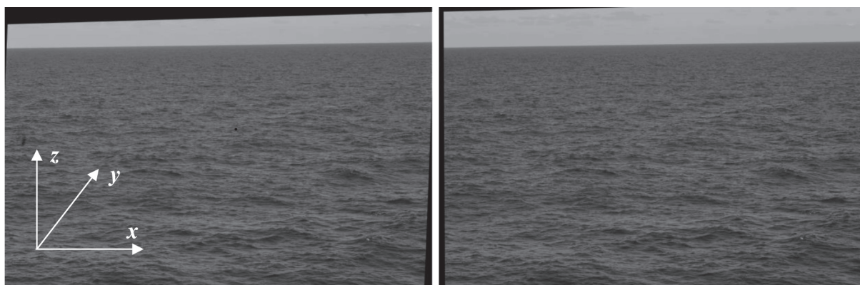
Рис. 1. Ректифицированная стереопара изображений морской поверхности при ветре 4.9 м/с (ось x сонаправлена с бортом судна, ось y направлена к горизонту перпендикулярно борту судна, ось z — вверх).
