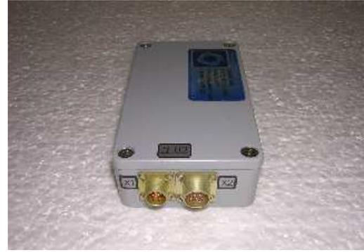
Рис. 2. Вариант исполнения модуля ГАКС в корпусе G106.
