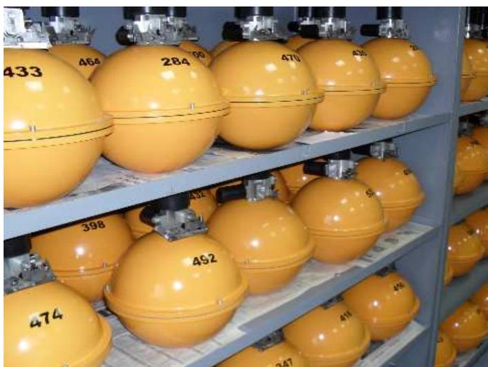
Рис. 10. Автономные донные станции, оборудованные аппаратурой ГАС-9 и предназначенные для реализации проекта «Тотальной донной сейсморазведки».
