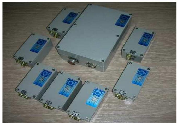
Рис. 3. Комплект гидроакустических модулей для оборудования глубоководного сейсмического полигона.
