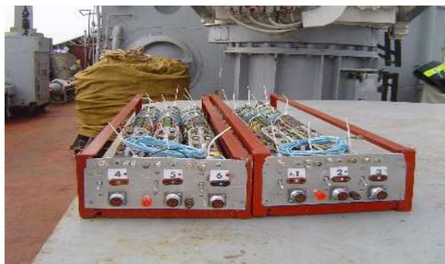
Рис. 8. Макет 6-канального усилителя мощности генератора подсветки.
