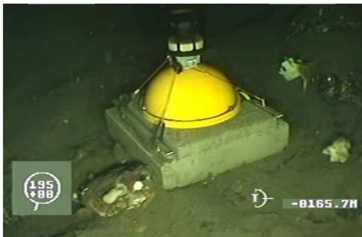
Рис. 9. Донная станция с аппаратурой ГАС-8 на дне.
