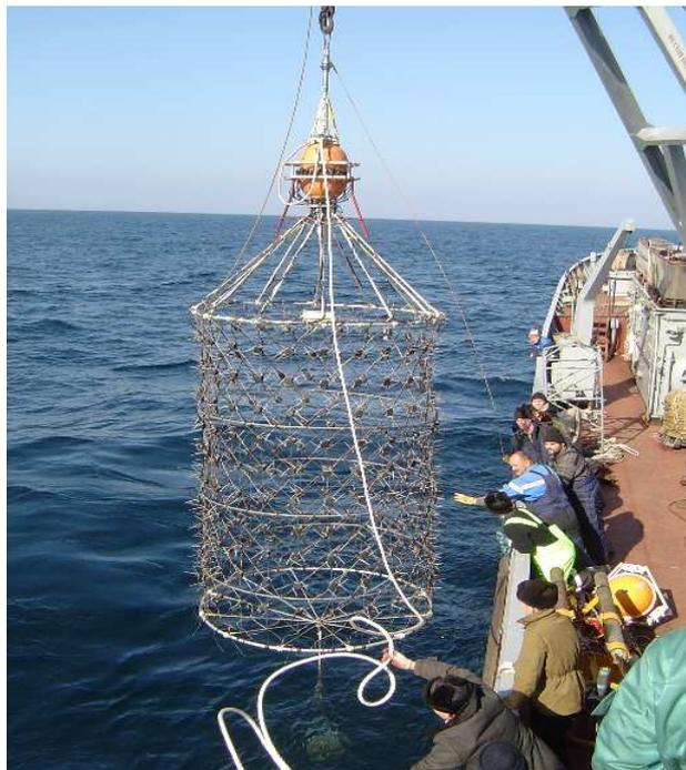
Рис. 5. Многоэлементная гидроакустическая антенна с управлением по ГАКС.
