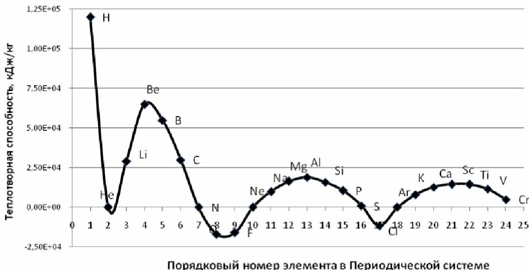
Рис. 5. Химическая активность элементов Периодической системы. Для окислителей теплотворная способность условно представлена в виде отрицательных величин.
