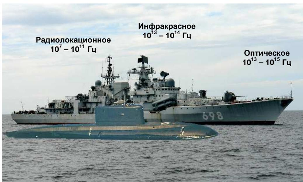
Рис.1. Электромагнитные поля кораблей в верхней полусфере.
