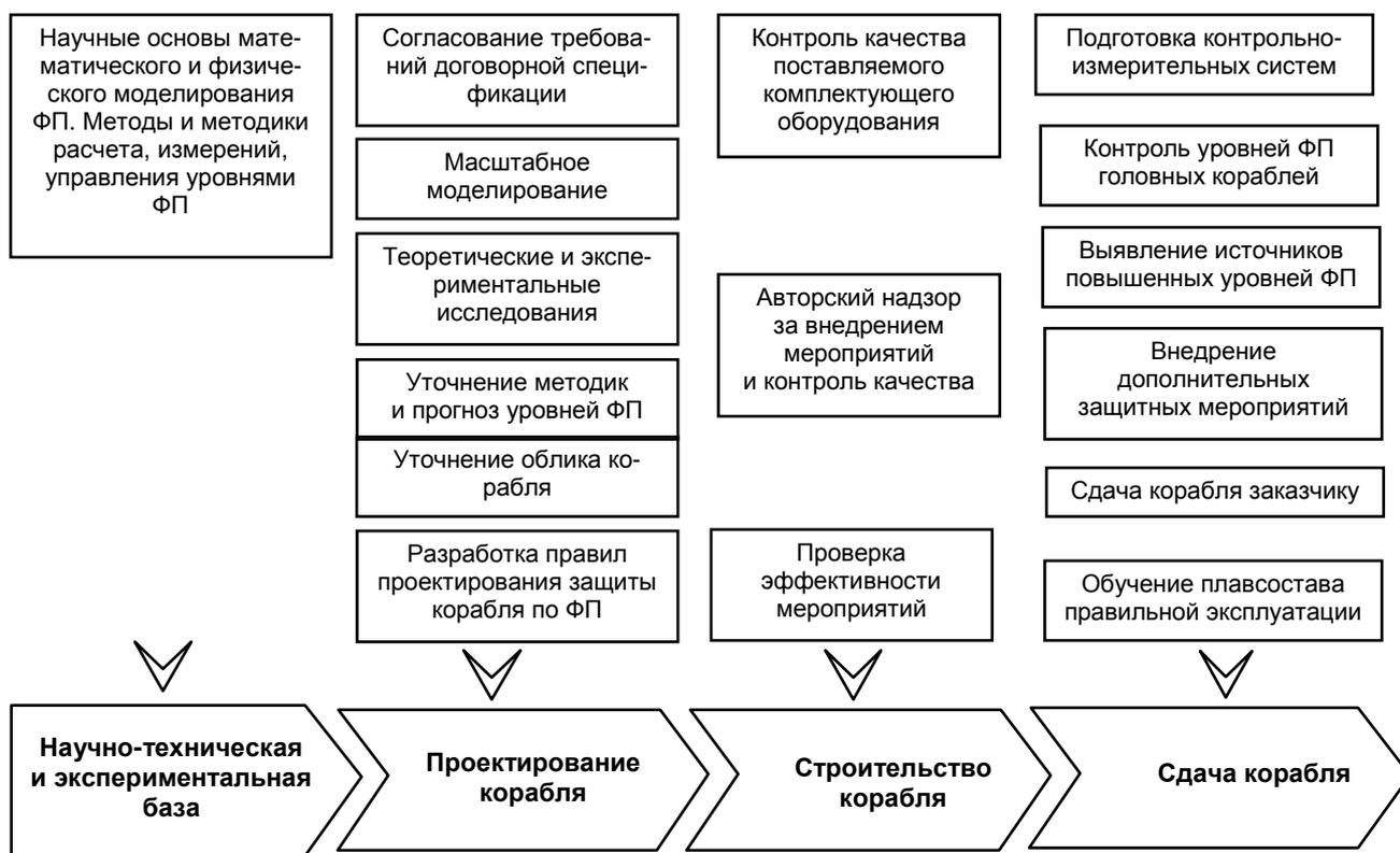
Рис.2. Схема работ института в обеспечение создания надводных кораблей с низким уровнем физических полей (ФП).
