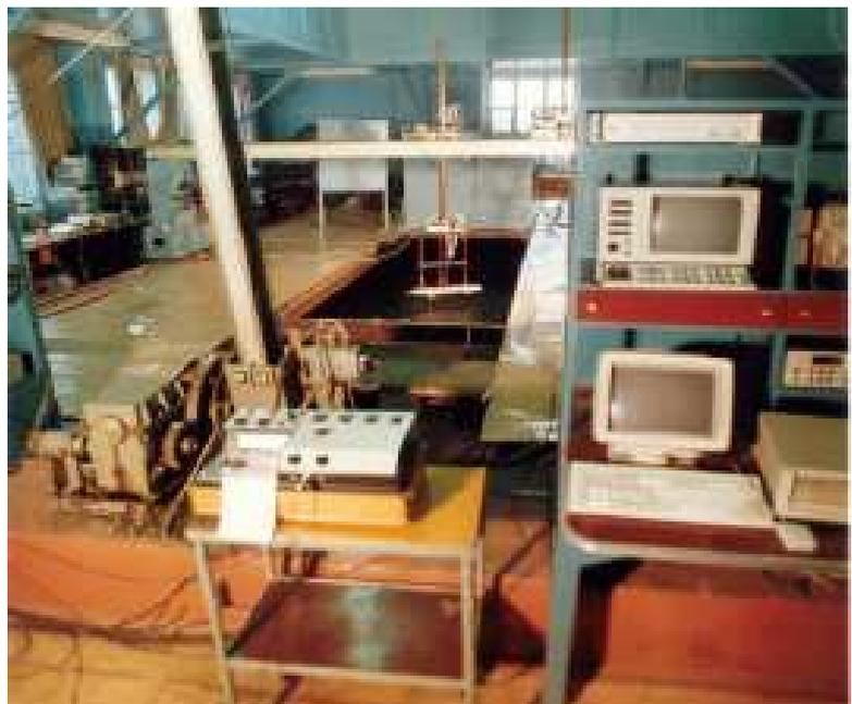
Рис.3. Стенд гидроакустического моделирования радиолокационных отражений.
