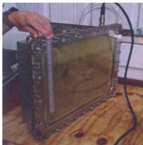
Рис. 28. Блок литий-полимерной батареи погружного исполнения аппарата AUTOSUB 6000.
