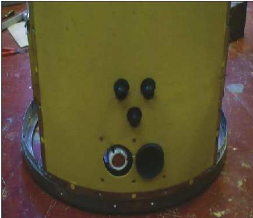
Рис. 24. Гидрофонный блок системы возвращения AUTOSUB 2.
