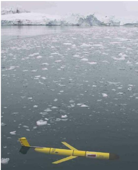
Рис. 30. Планирующий аппарат «Slocum».
