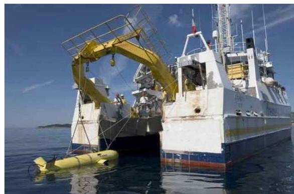
Рис. 13. Спуско-подъемное устройство НИС IFREMER с аппаратом «Explorer 3000».
