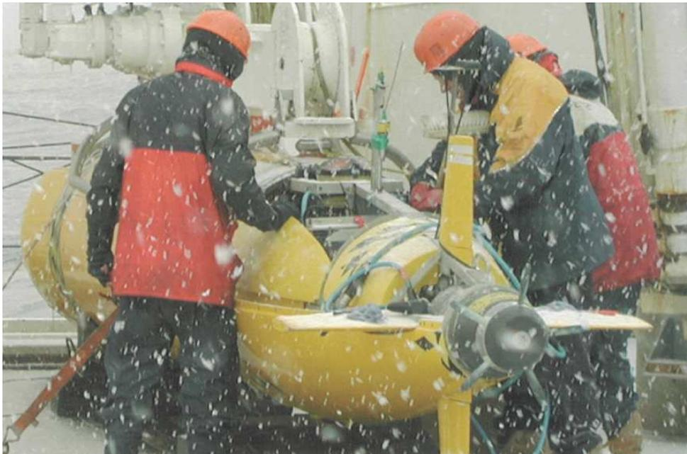
Рис. 18. Двигатель и рули AUTOSUB 2.
